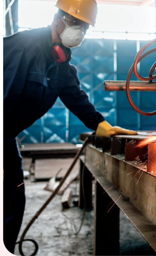
Beim Plasmaschneiden wird das Metall mit Hilfe eines Lichtbogens geschnitten. Dieser wird durch eine Kupferdüse verengt, die das Plasmagas stark komprimiert. Dort, wo der Plasmastrahl auf das Metall trifft, schmilzt es. Ein Gasstrahl oder Druckluft (bei Geräten für die heimische Werkstatt) sorgt dafür, dass das Material aus der Fuge herausgeblasen wird. Das Ergebnis ist ein sauberer Schnitt.
